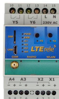
Do analogového vstupu, lze připojit například teplotní čidlo **KTY81-210**. Délka vodičů k připojenému externímu teplotnímu čidlu není omezena, ale je třeba uvážit, že delší vedení má určitý odpór, který má vliv na naměřenou hodnotu. (Platí, že 16 Ω představuje 1 °C).
