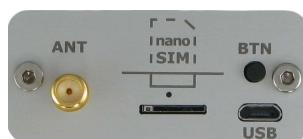
Micro USB konektor slouží ke konfiguraci pomocí SeaConfigurator.
