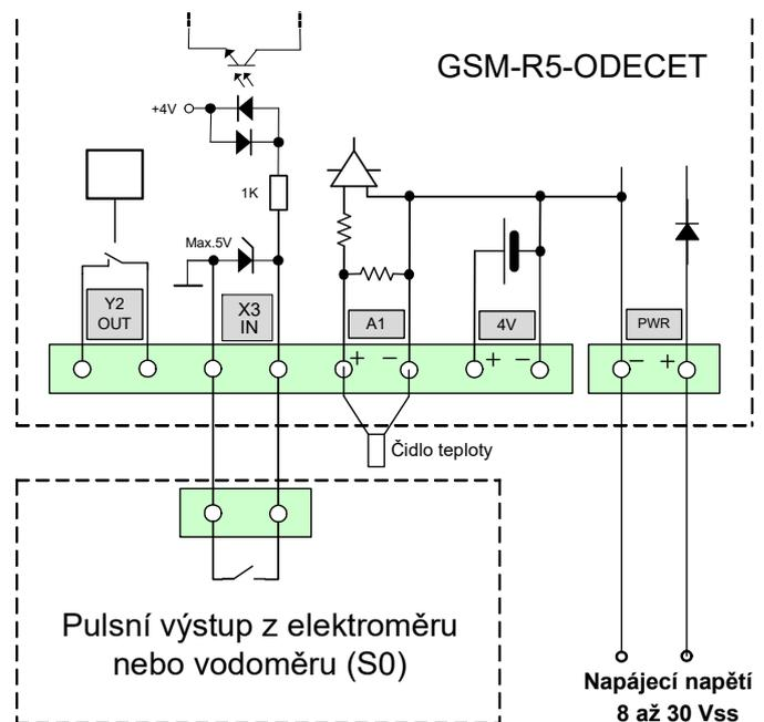
Pulsní výstup z elektroměru nebo vodoměru (S0)
