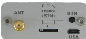
Micro USB konektor slouží ke konfiguraci pomocí SeaConfigurator.
