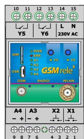
Do analogového výstupu, lze připojit například teplotní čidlo **KTY81-210**. Délka vodičů k připojenému externímu teplotnímu čidlu není omezena, ale je třeba uvážit, že delší vedení má určitý odpor, který má vliv na naměřenou hodnotu. (Platí, že 16 Ω představuje 1 °C).
