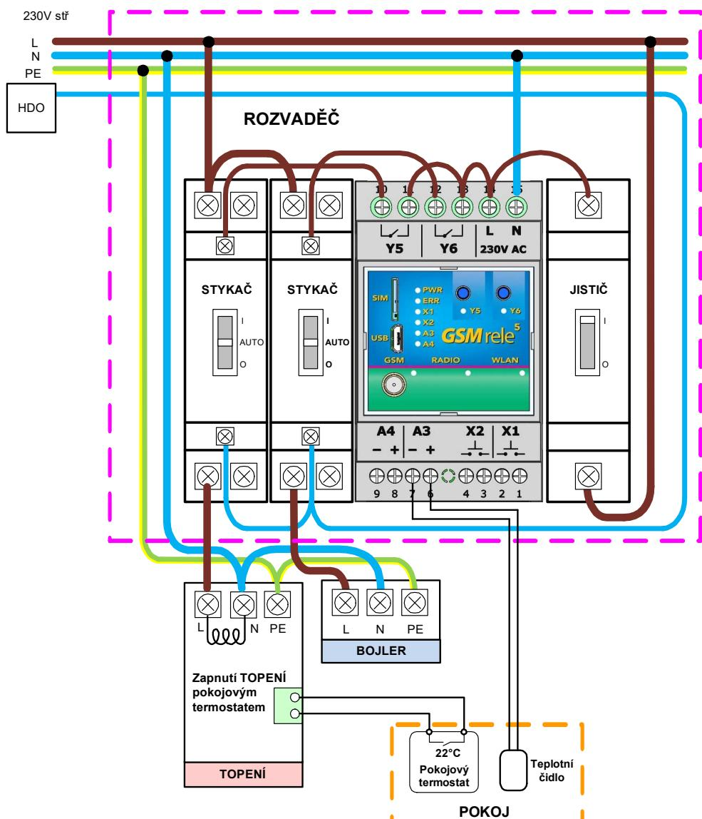
Toto zapojení funguje tak, že teplotní čidlo A3 je schopno regulovat (zapnout / vypnout) výstup Y5. To, že se A3 zapíná/vypíná podle Y5 je nastaveno v tovární konfiguraci.
