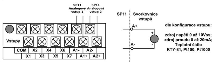
Hodnoty naměřeného napětí a proudu lze přepočítat na uživatelské jednotky, takže například změřený proud 10 až 20 mA se může zobrazovat jako tlak 0 až 5 MPa (viz konfigurační program SeaConfigurator).
