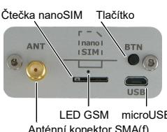
Anténa se ke GSM-MODBUS připojuje pomocí konektoru SMA. Zařízení je osazeno konektorem SMA female, připojovaná anténa musí mít konektor SMA male. Impedance je 50 Ω.
