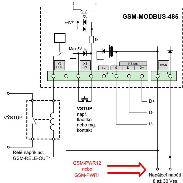
Zapojení terminátorů RS485 u GSM-MODBUS-485:
