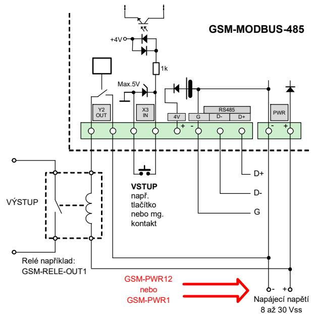
Zapojení terminátorů RS485 u GSM-MODBUS-485:
