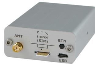
Vzdálenou správou se rozumí možnost odesílání SMS při změně registrů připojených zařízení a také možnost vzdáleného nastavení hodnot v registech připojených zařízení. GSM-MODBUS má kromě sériové linky také jeden digitální vstup a výstup pro obecné použití. Vstup se použije například pro hlídání, zda funguje připojené zařízení a výstup umožní jeho vzdálený reset. SMS dotazem lze kdykoliv zjistit stav GSM-MODBUS i stav předdefinovaných registrů v připojených zařízeních.
