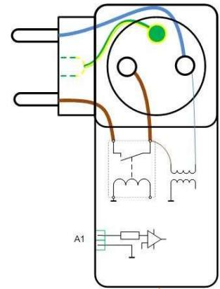
Na **GSM rele<sup>5</sup>** je síťová zástrčka a zásuvka pro připojení externího spotřebiče, jehož zapnutí nebo vypnutí je provedeno pomocí zabudovaného relé.
