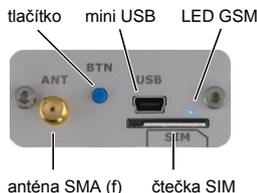
Mini USB konektor slouží ke konfiguraci pomocí SeaConfigurator.
