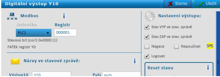
Upravenou konfiguraci je ještě třeba zapsat do GSM-MODBUS kliknutím na tlačítko **Do stanice**. Pokud necháte USB kabel připojen, můžete na záložce „Sledování“ sledovat aktuální provozní stav GSM-MODBUS. Pro ovládání je možno nadefinovat jména povelů, kterými lze nastavit hodnoty registrů v připojených zařízeních. Některé konfigurace (nastavení parametrů) je možno provést i pomocí SMS viz kapitola Seznam příkazů.
