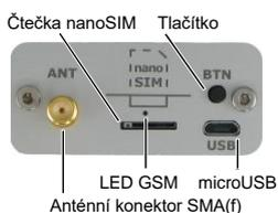
MicroUSB konektor slouží ke konfiguraci pomocí SeaConfigurator.
